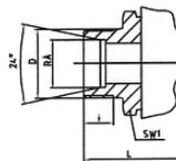
**04** Rohrverschraubung schwere Reihe
