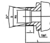
**03: Type 062240 (Verschraubung leichte Reihe/compression fitting light series)**
